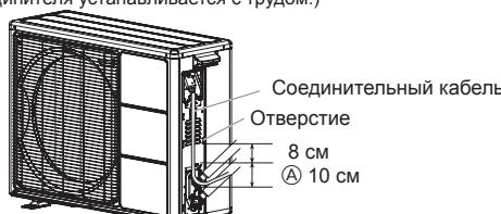
Как зафиксировать соединительный кабель и кабель питания кабельным зажимом
